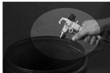
5. Поверните заливочный клапан вниз, чтобы открыть сливной клапан и дайте промывочной жидкости поциркулировать 15 секунд, чтобы очистить сливную трубку.
