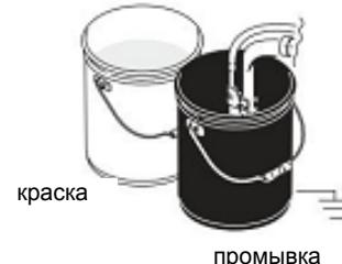
7. Поверните заливочный клапан вверх, чтобы закрыть сливной клапан. Направьте краскораспылитель в ведро с промывочной жидкостью и нажмите спусковой механизм, чтобы слить жидкость из шланга. Выключите питание.
