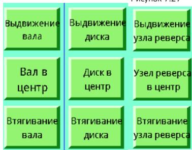
Выдвижение / центральное положение / втягивание гибочного узла (гибочный вал и диск) и механизма реверса стержней:
