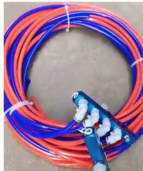
5. Подключите трубки к цилиндрам как показано на рис. 4.19. Красная трубка подключается к задней части цилиндра, синяя к передней (со стороны штока).
