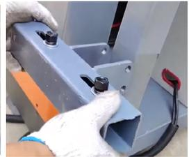
8. Установите муфту (соединитель) горизонтальной балки на вертикальную стойку лотка, которая находится ближе к станку (Рис. 4.12) и закрепите длинными крепежными болтами из комплекта.
