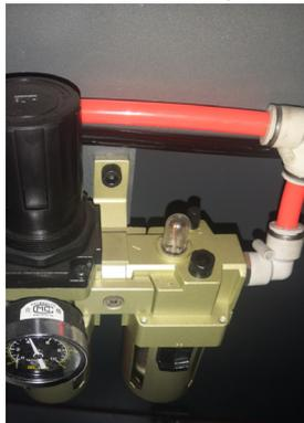
Для проверки исправной работы лубризатора используйте колбу (стаканчик), которая находится сверху лубризатора (рис 8.3). За колбой находится регулировочный клапан, с помощью которого регулируется количество подаваемой смазки.
