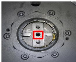
Для смазки добавьте небольшое количество масла в центральное отверстие гибочного вала (рис.8.4)
