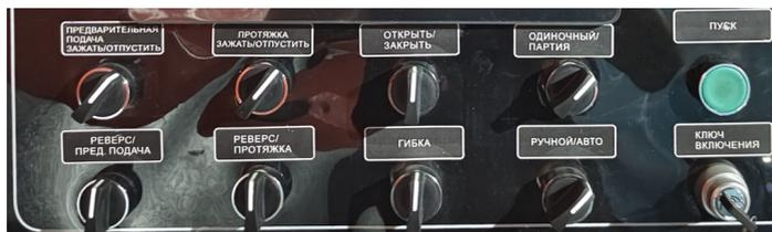
4. Проверьте работу приводов предварительной и основной протяжки (реверс/пред.подача; реверс/протяжка). Обратите внимание на направления вращения роликов.
