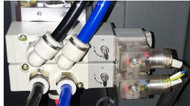
2. Проверьте исправность электромагнитных клапанов (рис.9.3).
